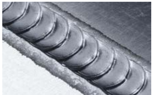
Überlappnaht 3 mm Aluminium Vd: 7,7 m/min Vs: 50 cm/min
