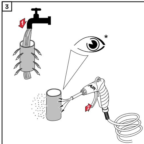
\* Si la cartouche filtrante ne peut plus être nettoyée sans dispositif d'aide, la remplacer.
