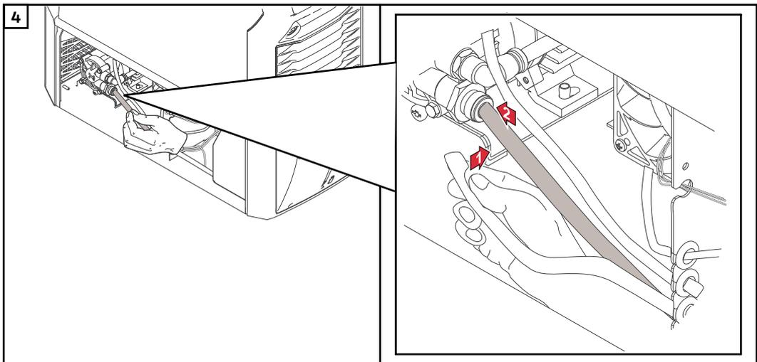
Brancher le tuyau de réfrigérant à la pompe à réfrigérant
