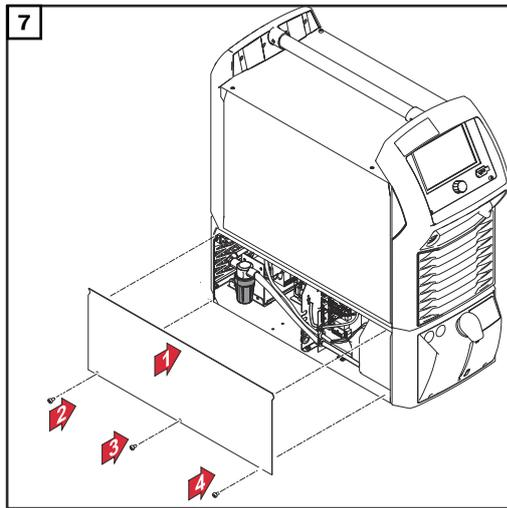
Couple de serrage des vis du boîtier = 3 Nm (2.21 ft lb)
