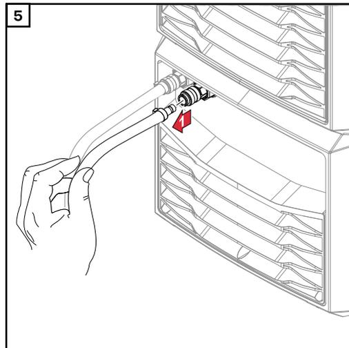
5 Débrancher le tuyau de réfrigérant du connecteur d'arrivée de réfrigérant
