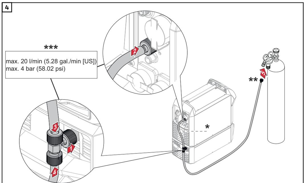
\* Tuyau de gaz fourni avec le refroidisseur (le tuyau de gaz n'est fourni que si l'option OPT/i CU Torch deflate est installée dans l'appareil de réfrigération)
