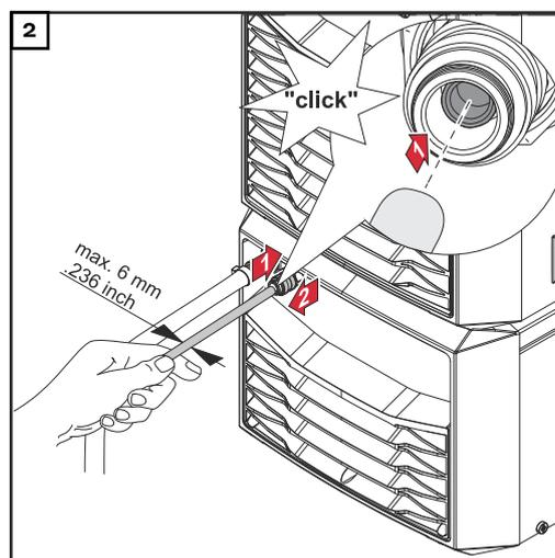
Tirer le cône d'étanchéité vers l'arrière dans le connecteur d'arrivée de réfrigérant
