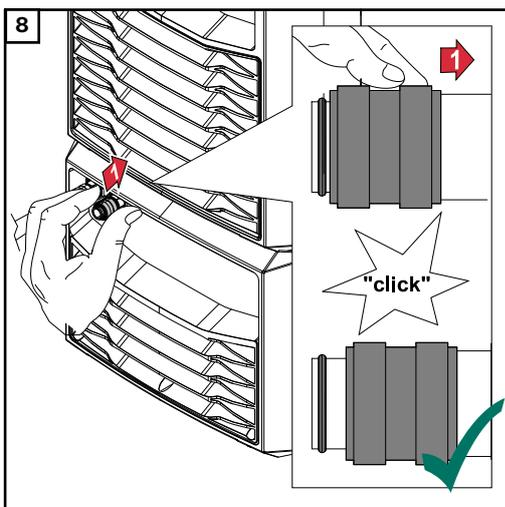
*Pousser la bague d'arrêt vers l'arrière jusqu'à ce que le cône d'étanchéité revienne dans sa position initiale puis relâcher la bague d'arrêt*
