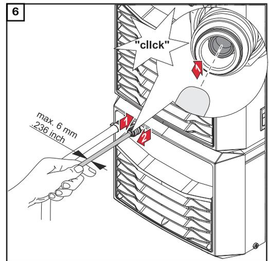
Pousser le cône d'étanchéité vers l'arrière dans le connecteur d'arrivée de réfrigérant
