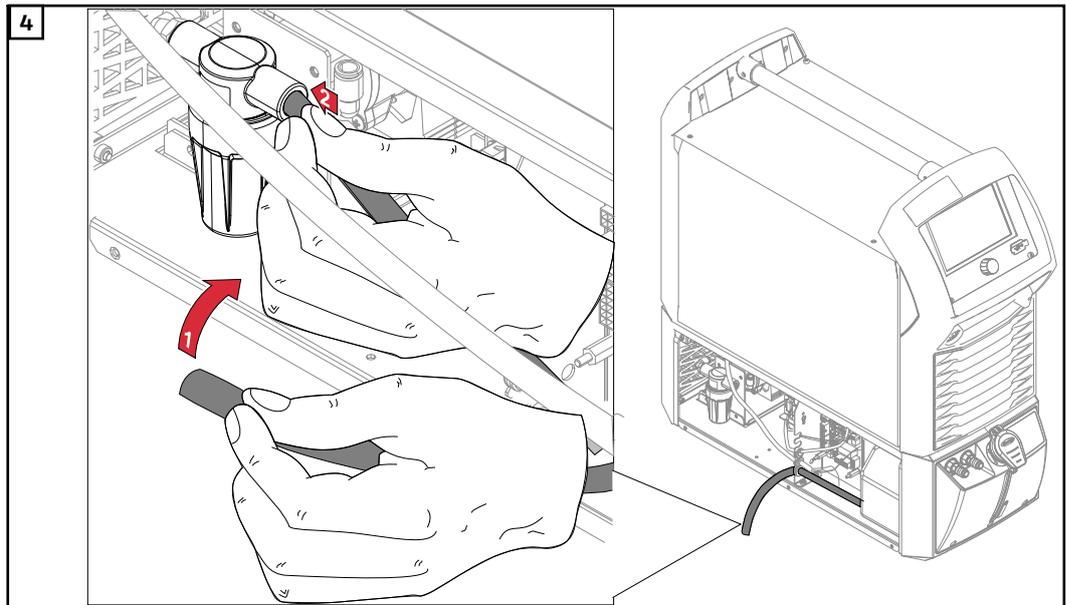
4 Insérer le tuyau de réfrigérant dans le préfiltre de réfrigérant
