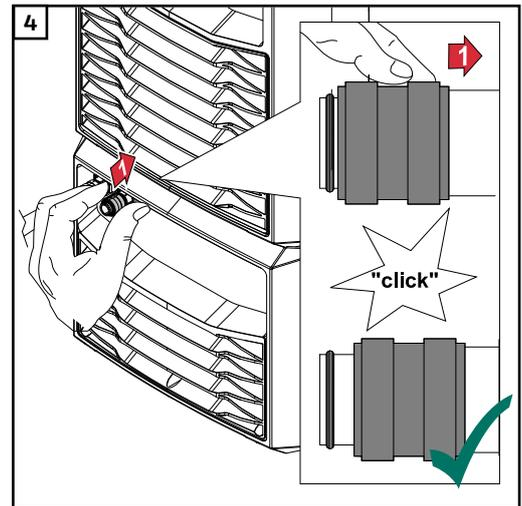
Tirer la bague d'arrêt vers l'arrière jusqu'à ce que le cône d'étanchéité revienne dans sa position initiale puis relâcher la bague d'arrêt
