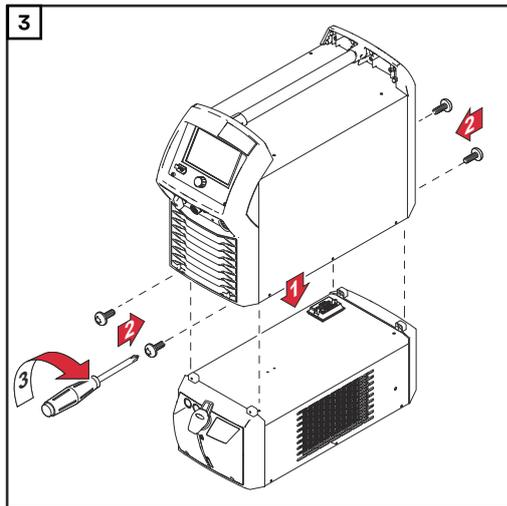
Pour visser la source de courant sur le refroidisseur, utiliser les vis livrées avec le refroidisseur.
