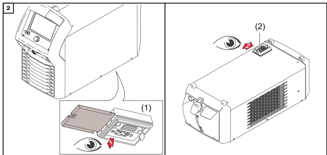
S'assurer que le connecteur du refroidisseur (1) et le connecteur de la source de courant (2) sont propres et ne sont pas endommagés
