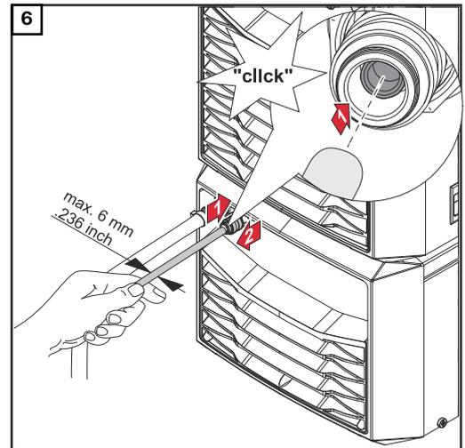
6 Pousser le cône d'étanchéité vers l'arrière dans le connecteur d'arrivée de réfrigérant
