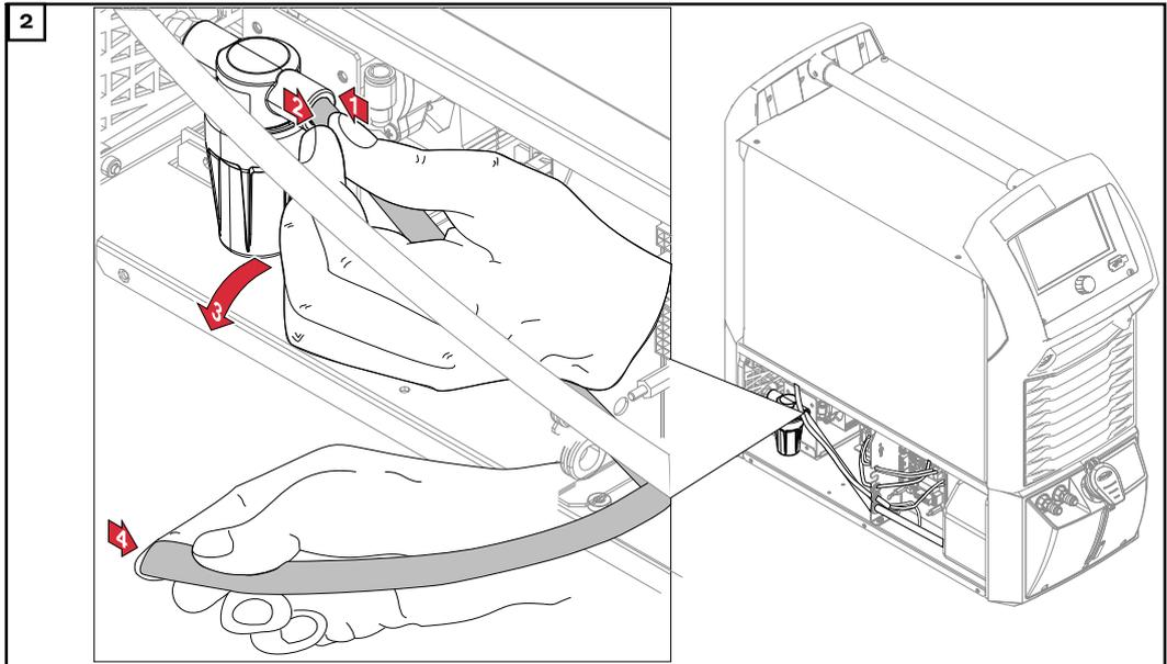
2 Réappuyer sur la borne Push-in au niveau du raccord du préfiltre de réfrigérant et tirer en même temps le tuyau de réfrigérant du préfiltre de réfrigérant
