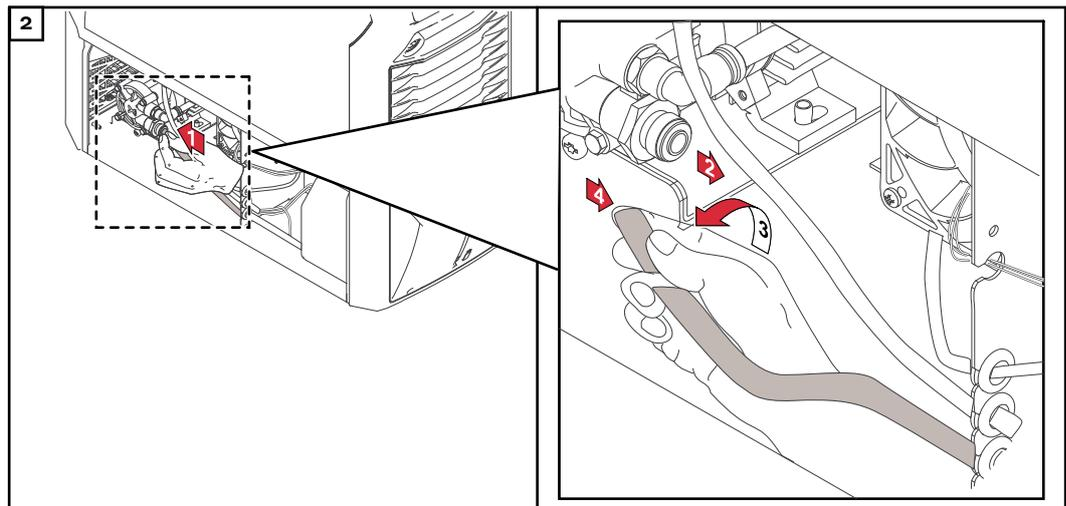
Réappuyer sur la borne Push-in au niveau de la pompe à réfrigérant et tirer en même temps le tuyau de réfrigérant de la pompe à réfrigérant
