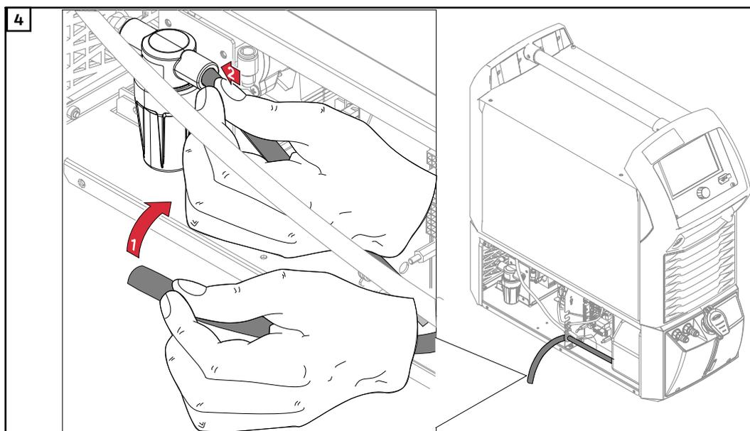
4 Inserir a mangueira do refrigerador no pré-filtro do refrigerador
