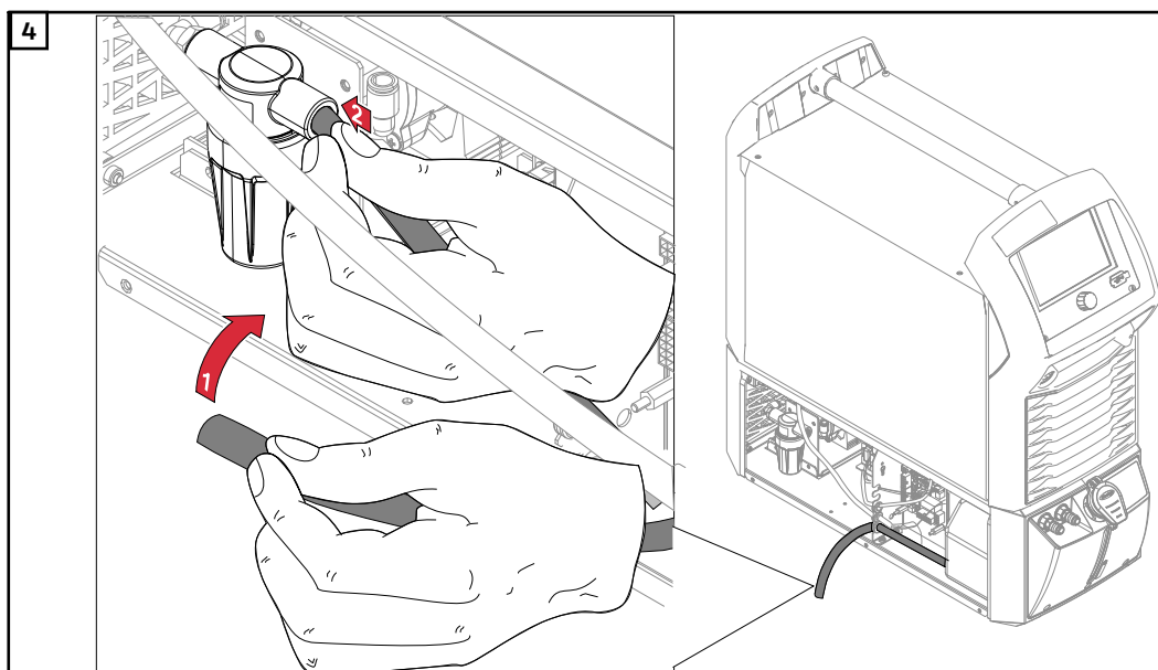
Przewód płynu chłodzącego wetknąć w filtr wstępny płynu chłodzącego
