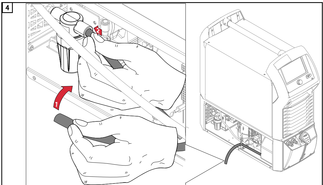
4 将制冷剂软管插入制冷剂前置过滤器
