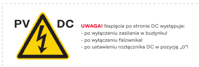
Rysunek 19: Etykieta wskazująca na stałą obecność napięcia DC.
