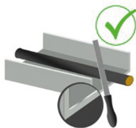
Rysunek 4: Gratowanie kanałów kablowych, tak aby izolacja przewodów pozostała nienaruszona przez dłuższy czas.
