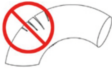
Rysunek 9: Należy nie doprowadzać do pęknięcia izolacji.
