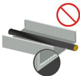
Rysunek 3: Koryto z zadziorami. Uwaga – niebezpieczeństwo uszkodzenia izolacji!
